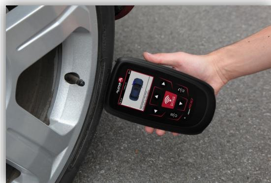
(Poznámka: u Banded senzorů od Fordu by měl přístroj být umístěn naproti/180° od ventilku)
