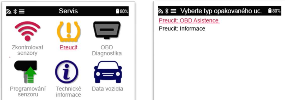
Pro informace o tom, jaké typy přeprogramování jsou dostupné pro váš typ vozidla, zapněte přístroj a zvolte „Relearn“ (přeprogramování). Můžete se také podívat na aktuální seznam pokrytí na [www.bartecautoid.com](http://www.bartecautoid.com) > Downloads.
