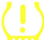
Při zapnutí zapalování by mělo dojít k zapnutí a vypnutí indikace TPMS, což indikuje, že se v systému nenachází chyby.
