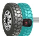
Bitte positionieren Sie das Gerät zwischen dem inneren und dem äußeren Rad, so nah wie möglich am Ventil, um das Auslesen des Sensors im inneren Rad zu verbessern.
