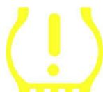
Wenn der Motor aus dem Stillstand gestartet wird, sollte die Warnleuchte an- und wieder ausgehen. Das würde auf ein fehlerfreies System hinweisen.
