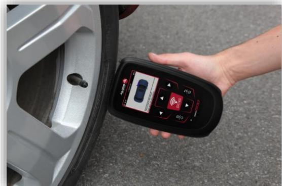
(Opomba: pri Ford Banded senzorjih je treba napravo držati 180 ° / nasproti položaja ventila)
