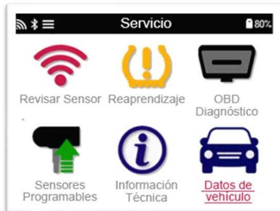
El menú da acceso directo a pantallas específicas que muestran los datos del vehículo. Esta opción es útil si el usuario desea echar un segundo vistazo a los datos del sensor, los datos OBD.
