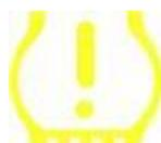
Cuando se enciende el motor para que funcione, el indicador del TPMS debe encenderse y apagarse. Esto indicaría que el sistema no tiene ninguna falla.
