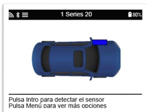
Utilice las teclas de flecha para seleccionar el sensor que necesita ser leído.
