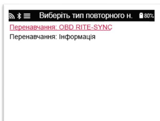
Щоб дізнатися, який тип повторного включення доступний для автомобіля, просто увімкніть інструмент і виберіть Relearn (Перенавчання). Або зверніться до поточного списку покриття на сайті [www.bartecautoid.com](http://www.bartecautoid.com) > Завантаження.
