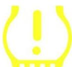
При включені запалювання і виключенні для роботи контрольний сигнал TPMS повинен загорітися, а потім згаснути. Це вказувало б на те, що в системі немає несправності.
