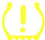
Při zapnutí zapalování by mělo by mělo dojít k zapnutí a vypnutí indikace TPMS, což indikuje, že se v systému nenachází chyby.
