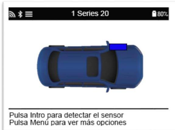
Utilice las teclas de flecha para seleccionar el sensor que necesita ser leído.
