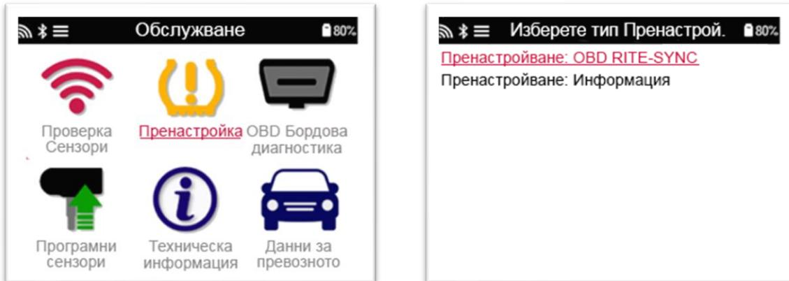
За да разберете кой тип пренастройване е достъпен за превозно средство, просто включете инструмента и изберете Relearn. Или вижте текущия списък на обхвата в [www.bartecautoid.com](http://www.bartecautoid.com) > Изтегляния.
