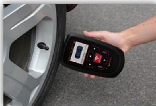
(Забележка: при лентовите сензори на FORD инструментът трябва да се държи на 180°/ срещуположно на позицията на стъблото)
