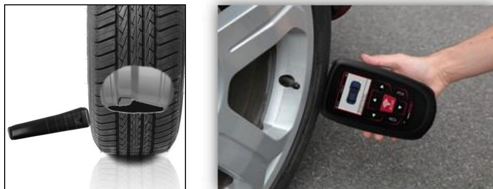
(Poznámka: u Banded senzorů od Fordu by měl přístroj být umístěn naproti/180° od ventilku)
