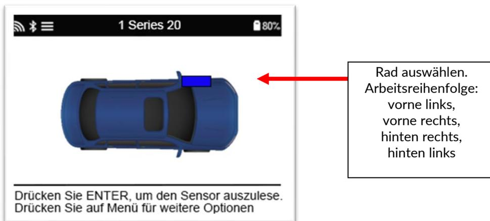
Neben dem Druck und der Temperatur wird auch der „Modus“ des Sensors gezeigt. In einigen Fällen kann der Modus nicht geändert werden und ist nicht wichtig, aber in anderen Fällen muss er geändert werden, damit das Anlernen funktioniert.
