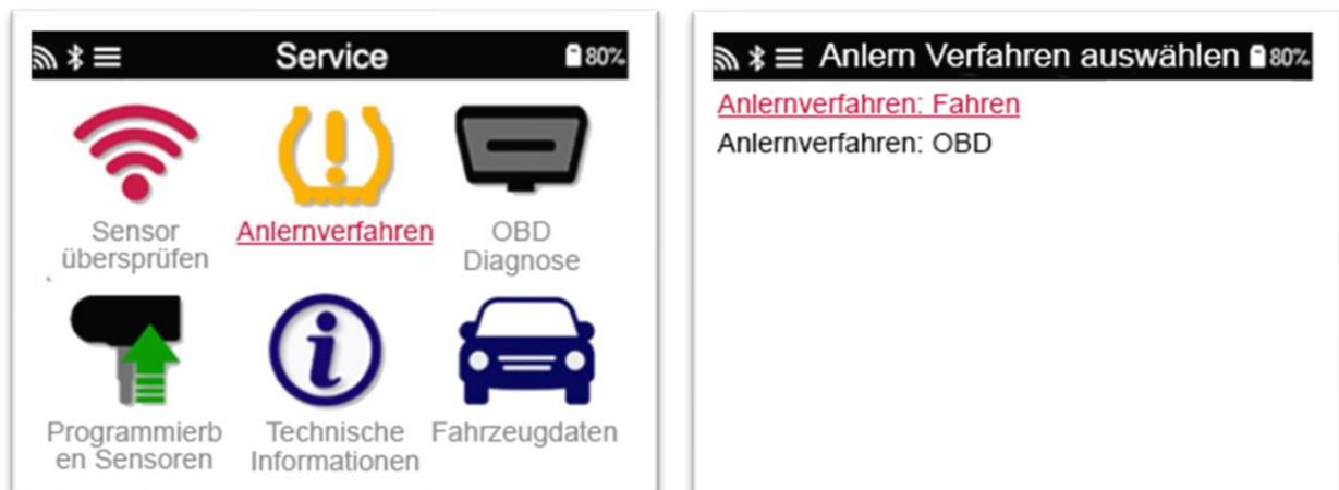
Um herauszufinden welche Anlernverfahren für das Fahrzeug verfügbar sind, schalten Sie Ihr Gerät an und wählen Sie Sensoren anlernen aus. Oder sehen Sie sich unsere aktuelle Abdeckungsliste an unter [www.bartecautoid.de](http://www.bartecautoid.de) > Downloads.
