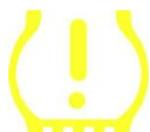
Wenn der Motor aus dem Stillstand gestartet wird, sollte die Warnleuchte an- und wieder ausgehen. Das würde auf ein fehlerfreies System hinweisen.
