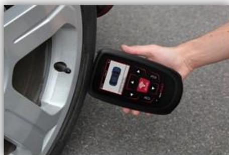
(Hinweis: Bei manchen Ford Sensoren muss das Gerät um 180° vom Ventil positioniert werden.)
