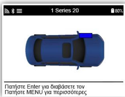
Εκτός από την πίεση και τη θερμοκρασία, εμφανίζουμε επίσης τη «λειτουργία» του αισθητήρα. Σε ορισμένες περιπτώσεις, ο τρόπος λειτουργίας δεν μπορεί να αλλάξει και δεν είναι σημαντικός, αλλά σε ορισμένες περιπτώσεις θα πρέπει να αλλάξει για να λειτουργήσει η εκμάθηση.
