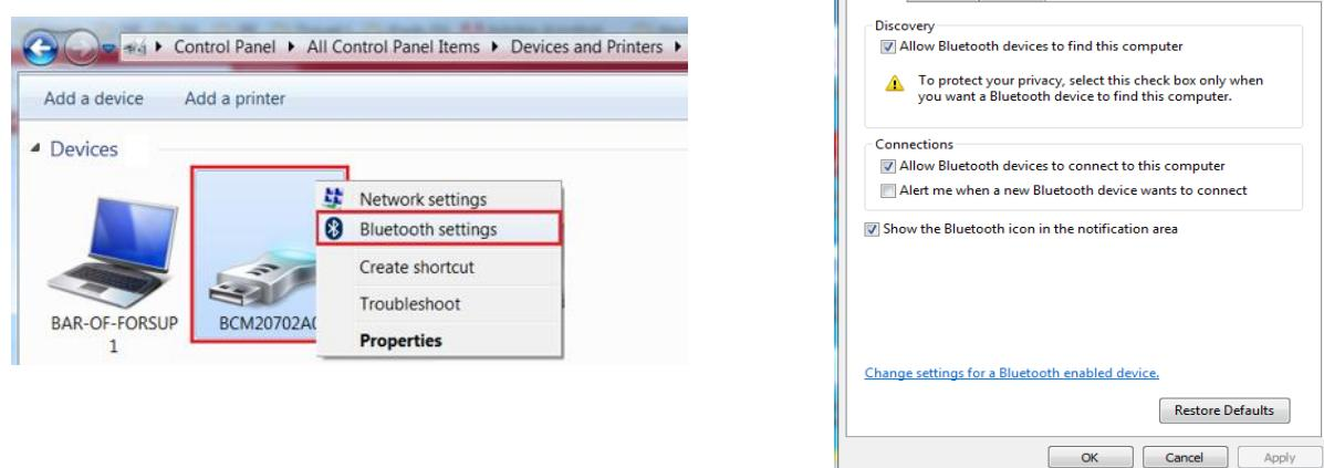
Κάντε δεξί κλικ στο εικονίδιο Bluetooth dongle και κάντε κλικ στις ρυθμίσεις Bluetooth. Επιλέξτε τα πλαίσια όπως φαίνεται στην καρτέλα Επιλογές παραπάνω. Πατήστε OK όταν τελειώσετε.
