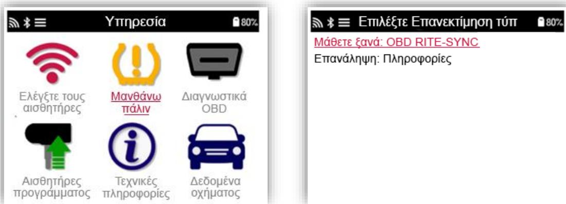
Για να μάθετε ποιος τύπος επανεκμάθησης είναι διαθέσιμος για ένα όχημα, απλώς ενεργοποιήστε το εργαλείο και επιλέξτε Relearn. Ή ανατρέξτε στην τρέχουσα λίστα κάλυψης στη διεύθυνση [www.bartecautoid.com](http://www.bartecautoid.com) > Λήψεις.
