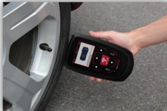
(Nota: com sensores Ford Banded, a ferramenta deve ser mantida 180 ° / oposta à posição da haste)
