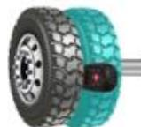
Para melhorar a leitura do sensor da roda interna, posicione a ferramenta entre a roda externa e interna, o mais próximo possível do sensor.
